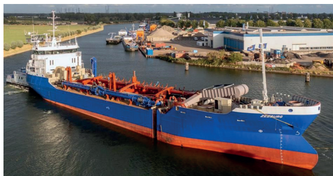
Die Düsenleitungen aus HDPE ecoFIT an Bord der MS Zeeburg sind für den Abbauprozess essenziell.
