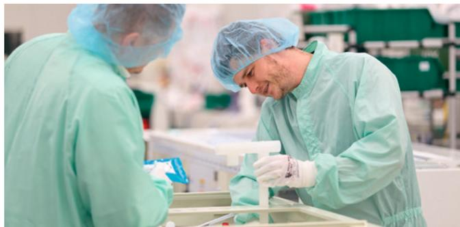
Um höchste Sicherheits- und Reinheitsstandards zu erfüllen, werden SYGEF Plus-Teile (PVDF-HP) im Doppelbeutel verpackt.
