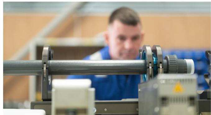
IR PVC-U kombiniert die Stärken des PVC-U Materials mit den Vorteilen des Infrarotschweissens, welche reproduzierbare, sichere und zuverlässige Verbindungen bietet. Quelle: GF Piping Systems
