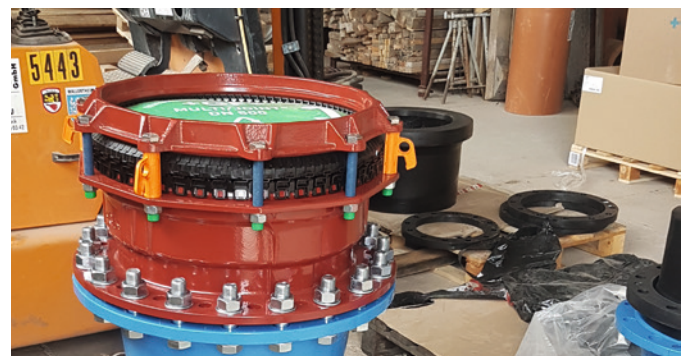
MULTI/JOINT 3000 Plus: schneller und sicherer Materialübergang auch bei DN 500.
