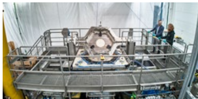
Die Anlage nutzt Prozessautomatisierung von GF Piping Systems, um die 798 Spiegelelemente des ELTs zu reinigen.
