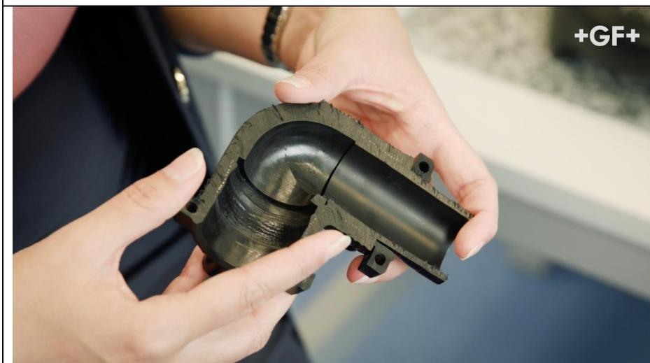
A importância do treinamento – uma soldagem por eletrofusão com falha (90% de todas as reclamações são devido à tecnologia de juntas realizadas de maneira errada).
