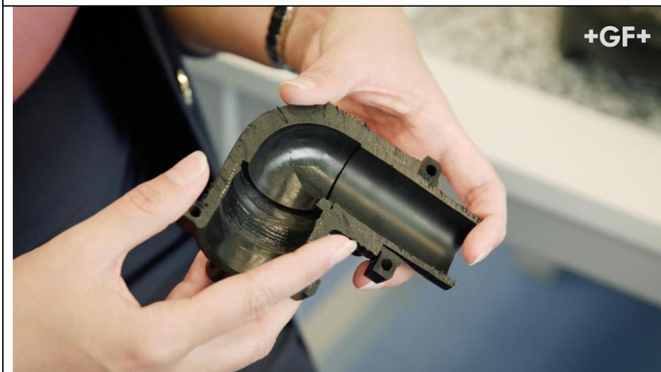
L'importanza della formazione: una saldatura per elettro fusione non riuscita (il 90% di tutti i reclami è dovuto a una tecnologia di giunzione non riuscita).
