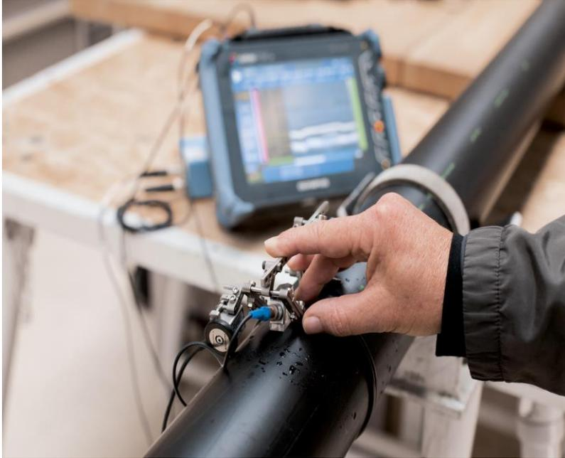
Zerstörungsfreies Testen per Ultraschall sorgt für leckagefreie Rohrleitungssysteme in Rechenzentren.
