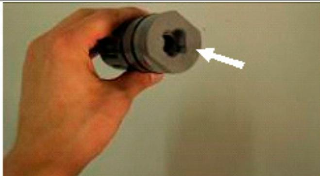
4. Sicherstellen, dass der Zapfen mit den seitlichen Führungen des Aufsatzes bündig ist.
