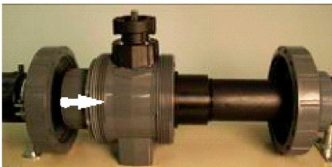
6. Einlegeteil positionieren und Überwurfmutter auf beiden Seiten verschrauben. Überwurfmutter mit einem geeigneten Schlüssel anziehen.
