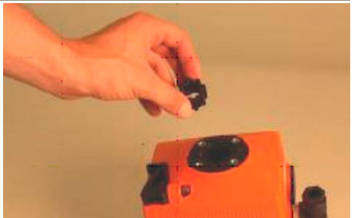
5. Adapterplatte mit vier Senkschrauben an den Antrieb montieren.
