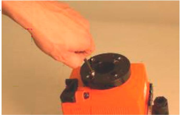
6. Reduzierhülse auf den Zapfen des Kugelhahns setzen.
