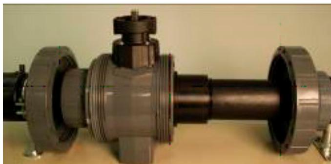
6. Einschraubteil herausdrehen (Linksgewinde!) und zur Seite schieben.
