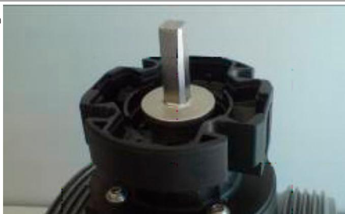
5. Einschraubteil in das Schutzgehäuse (Linksgewinde!) schrauben und mit dem Zapfenschlüssel anziehen.
