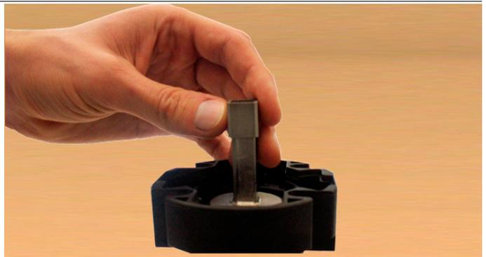
7. Antrieb mit der Adapterplatte auf das Anschlussmodul des Kugelhahns montieren.
