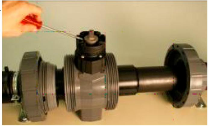
9. Gehäuse zur Seite des Einlegteils schieben. Der Kugelhahn ist nun zugänglich
