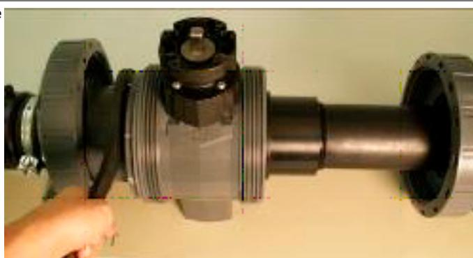
8. Zapfen aus dem Gehäuse drücken. Eine Einkerbung am Zapfen ermöglicht die Verwendung eines Schraubendrehers.
