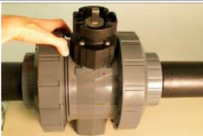
7. Handhebel auf das Gehäuse montieren.
