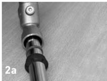
Passer la bague en plastique rouge sur le tube entre le corps et douille en plastique avec le cône contre le corps. (voir photo 2b, détail)
