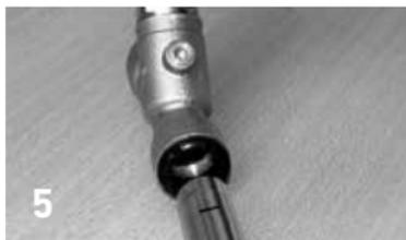
Contrôle optique du raccord pour vérifier sa propreté et l'assise correcte du joint torique avant d'insérer le tube. Insérer le tuyau jusqu'au marquage avec un léger mouvement de rotation.
