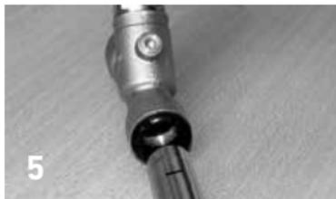
Gehäuse vor dem Einstecken des Rohres auf Sauberkeit und korrekten Sitz des O-Rings optisch überprüfen.
