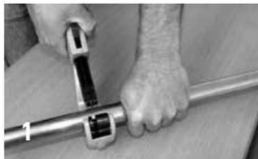
Chromstahl- oder Kupferrohr mit handelsüblichem Rohrabschneider oder feinzahniger Säge ablängen.
