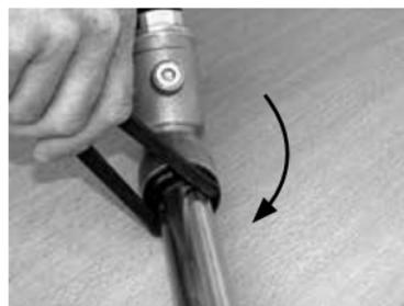
Kunststoff-Hülse mit Schlüssel durch drehen im Uhrzeigersinn bis zum Anschlag anziehen.
