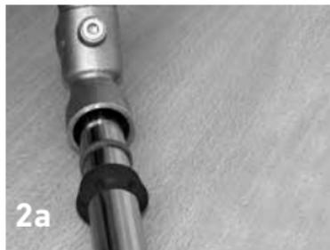
Roten Kunststoffring, mit Konus gegen Gehäuse, zwischen Gehäuse und Kunststoff-Hülse über das Rohr stülpen. (Siehe Bild 2b, Detail)
