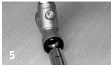
Controllare visivamente se il corpo è pulito prima di inserire il tubo e se la guarnizione O-ring è perfettamente posizionata. Inserire il tubo girando leggermente fino a raggiungere la marcatura. Tirare il tubo per controllare
