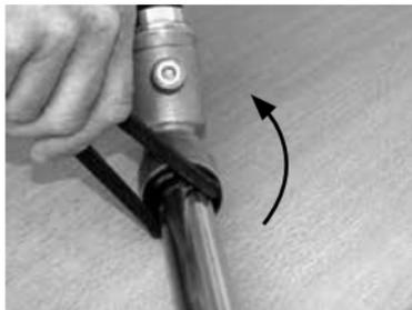
Kunststoff-Hülse mit Schlüssel durch drehen im Gegenuhrzeigersinn lösen.
