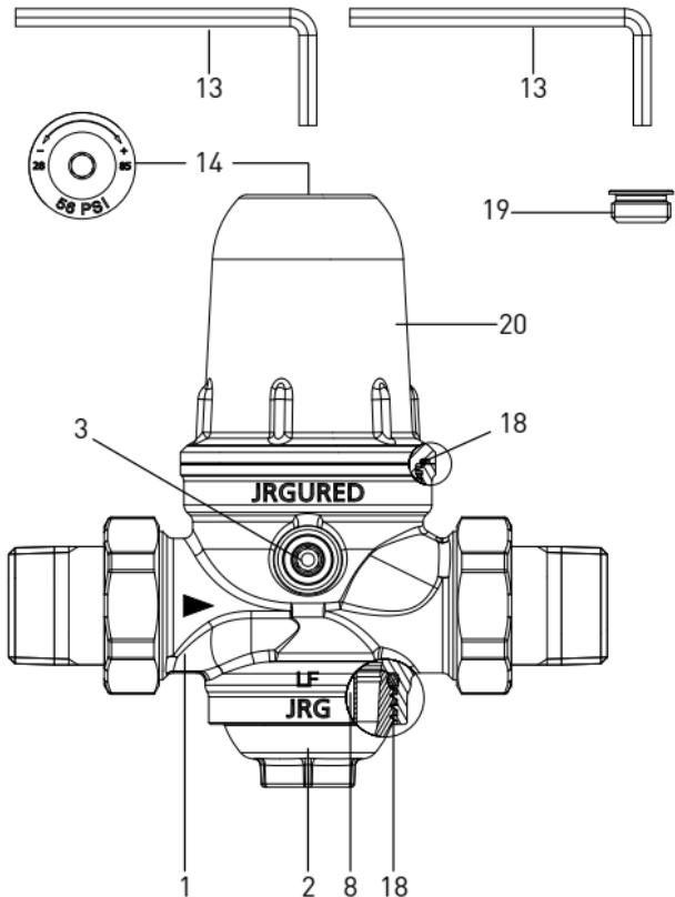
Zuerst mit dem Sechskant-Stiftschlüssel den Stopfen **19** im Metalloberteil entfernen bevor die Druckeinstellung an der darunterliegenden Schraube vorgenommen werden kann.
