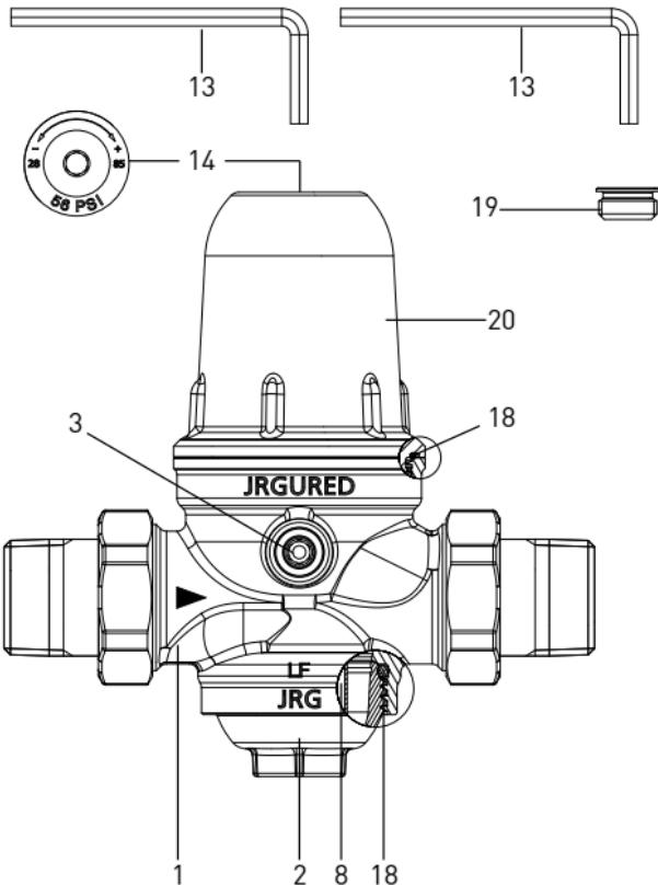
Dévisser d'abord et enlever le bouchon **19** du chapeau en métal avec la clé à six pans avant de régler la pression au moyen de la vis qui se trouve dessous.
