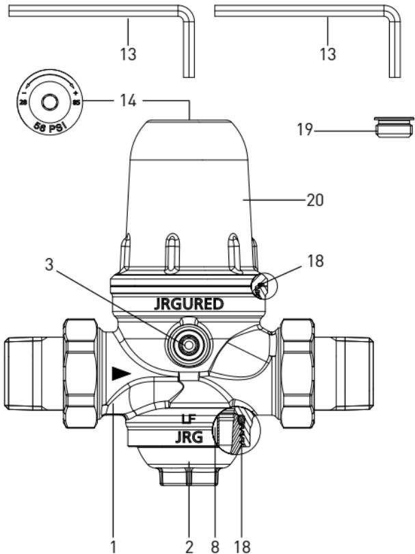
Svitare con la chiave esagonale il tappo **19** dalla parte superiore in metallo prima che si possa regolare la pressione con la vite di regolazione sotto il tappo svitato.
