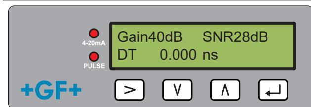
낮은 이득(-5dB~80dB의 데시벨 값)이 더 좋은 것이며, 이득은 40dB 이하여야 합니다. 값이 60dB를 넘으면 설치 상태를 점검하십시오.
