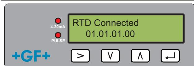
La ligne inférieure affiche la version du micrologiciel de la RTD en platine. L'état est indiqué dans la ligne supérieure.
