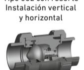
La válvula está ajustada en el nivel de la columna de agua de 1 m
