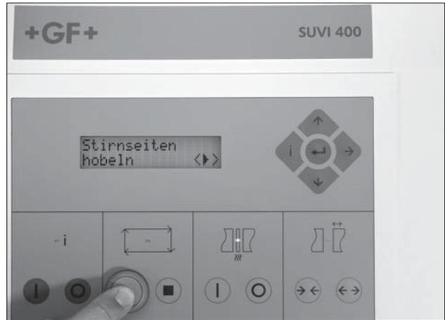
Auf dem Display blinkt abwechselnd: Hobel einlegen und Stirnseite hobeln. Drücken Sie die grüne Taste ► bis die rote Kontrollleuchte in diesem Feld leuchtet.
