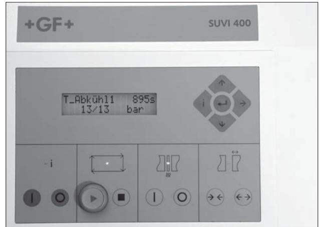
Auf dem Display wird angezeigt, wenn die Abkühlzeit beendet ist. Drücken Sie die grüne Enter Taste. Das Schweissgerät entlastet die Schweissung.
