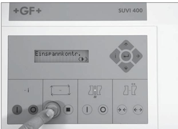
Auf dem Display erscheint: Einspannkontr. Drücken Sie die grüne Taste ► bis die rote Kontrollleuchte in diesem Feld leuchtet. Das Schweissgerät führt eine automatische Kontrolle der Einspannung durch.
