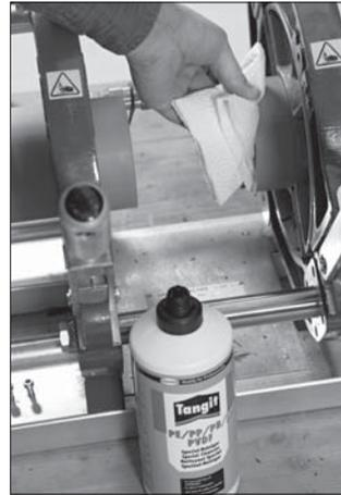
Reinigen Sie die Verbindungsflächen der zu verschweißenden Teile – Fitting und Rohrende. Benutzen Sie zum Reinigen ein saugfähiges, nichtfaserndes Papier und Reinigungsmittel **Tangit KS-Reiniger, Art.- Nr. 799 298 023**. Entfernen Sie die Reinigungsflüssigkeit restlos mit dem Reinigungspapier.
