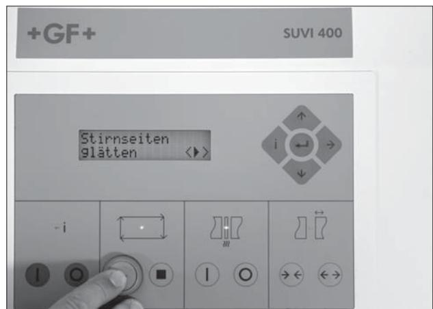
Auf dem Display erscheint: Stirnseiten glätten. Drücken Sie die grüne Taste ► bis die rote Kontrollleuchte in diesem Feld leuchtet. Wenn auf beiden Rohrenden ein Hobelspan ohne Unterbrechungen abgehobelt wurde, bestätigen Sie mit der grünen Taste ► bis die rote Kontrollleuchte in diesem Feld leuchtet.
