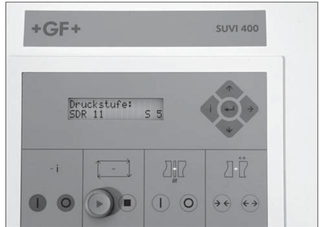
Auf dem Display blinkt: Druckstufe: SDR 11, S 5. Die Druckstufe gibt an, für welchen Druck das Rohr ausgelegt ist.
