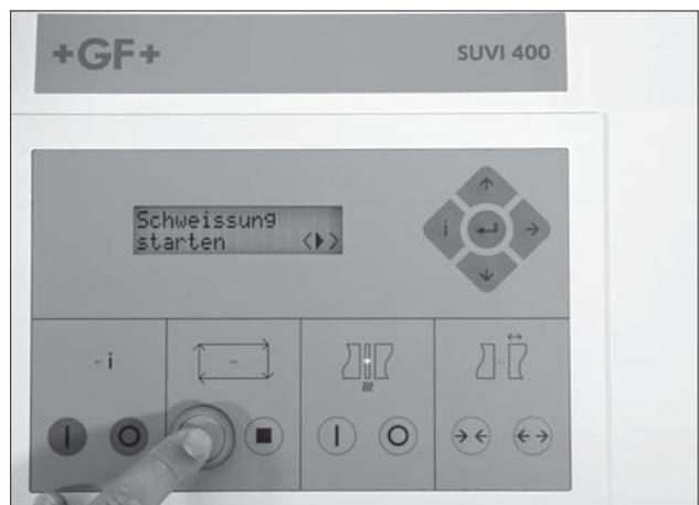
Auf dem Display erscheint: Schweißung starten. Drücken Sie die grüne Taste ► bis die rote Kontrolllampe in diesem Feld leuchtet. Die beiden Rohre oder das Rohr und der Fitting fahren zusammen.
