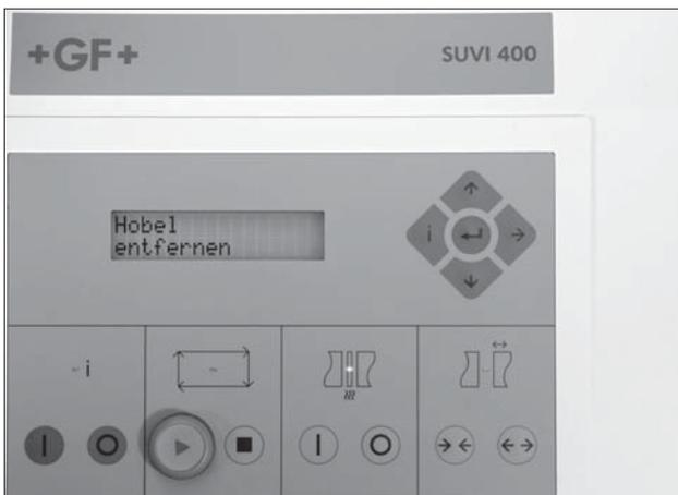
Auf dem Display erscheint: Hobel entfernen. Der Hobelvorgang ist beendet und der Hobel schaltet automatisch ab. Wenn der Hobel abgeschaltet ist, nehmen Sie ihn aus der Schweissvorrichtung und stellen ihn zurück in die dafür vorgesehene Haltevorrichtung.
