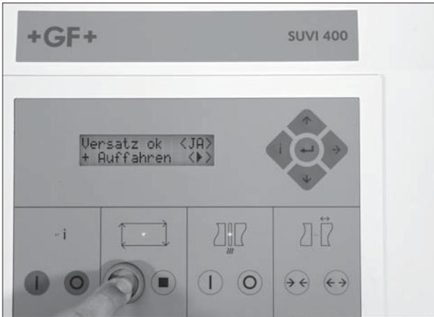
Auf dem Display erscheint: Versatz ok <JA> + Auffahren. Der Versatz zwischen den Rohren oder Rohr und Fitting ist kleiner als < 1 mm. Drücken Sie die grüne Taste ►. Ist der Versatz > 1 mm zwischen den Rohrenden oder Rohr und Fitting können Sie die Rohrenden auffahren, in dem Sie die grüne Taste ► betätigen, bis die rote Kontrollleuchte in diesem Feld leuchtet. Die Rohre verdrehen, so dass der Versatz 1 mm ist.
