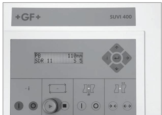
Auf dem Display erscheinen die folgenden Angaben: Das Material, die Dimension und die Druckstufe. Prüfen Sie diese Angaben.
