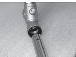
4 Le tuyau peut être sorti du raccord instantané.
