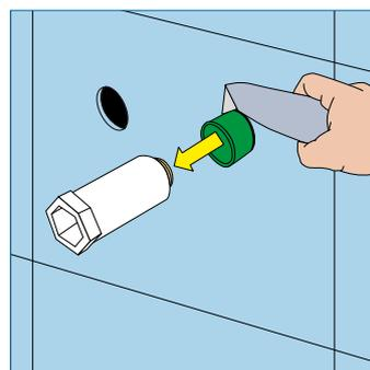
Vor der Montage der Armatur wird die Tropfhülse wandbündig gekürzt. Für das Ablängen reicht ein Cutter- oder Hakenmesser. Der Baustopfen kann danach einfach herausgeschraubt werden.
