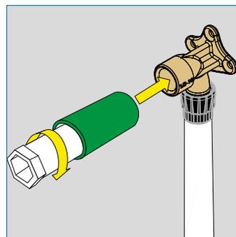
Die Tropfhülse wird über den Armaturenanschluss geschoben, ausgerichtet und dichtet nach aussen ab. Dies sollte vor der Montage des Baustopfens geschehen.
