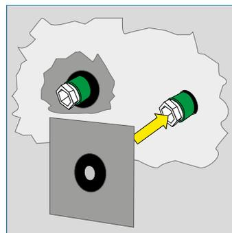
Die Dichtmanschette wird über die Tropfhülse gezogen und liegt direkt an dieser an.
