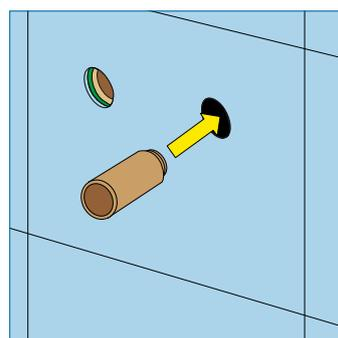
Bei Bedarf werden anschliessend die Hahnverlängerungen eingedreht. Ansonsten erfolgt die Montage der Armatur, der Eckventile o.ä. wie gewohnt.
