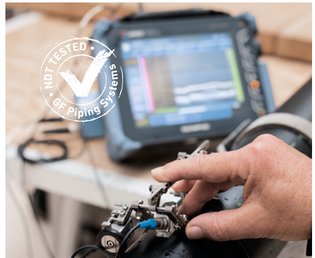
Scannen Sie Stumpfschweißnähte mit unseren maßgeschneiderten Ultraschallsensoren
