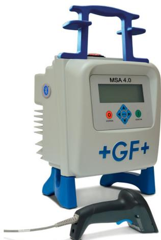
Dank der Inverter Technologie verbindet das Gerät niedriges Gewicht mit hoher Leistungsfähigkeit, sowie eine komplette Schweißdokumentation, einschliesslich Bedienerausweis, Auftragsnummer, Produktrückverfolgung von Rohrleitungskomponenten (ISO 12176) und Positionsbestimmung der Schweißverbindung mit eingebautem GPS Empfänger.
