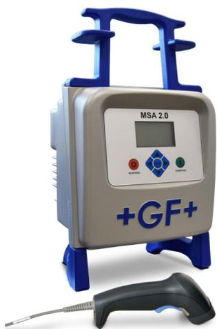
Das automatische Elektroschweisgerät MSA 2.0 verbindet dank der Inverter Technologie niedriges Gewicht mit hoher Leistungsfähigkeit. Das Gerät ist extrem einfach und schnell zu bedienen, lediglich drei Aktionen genügen um eine Schweißung auszuführen: Anschluss der Schweißkabel, Einlesen des Schweiß-Barcodes, Start der Schweißung. Das MSA 2.0 hat eine Speicherkapazität für bis zu 350 Protokolle, welche am Display angezeigt werden können.
