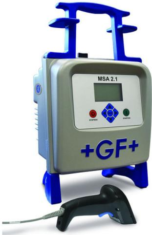
Das automatische Elektroschweisgerät MSA 2.1 verbindet dank der Inverter Technologie niedriges Gewicht mit hoher Leistungsfähigkeit, sowie eine Schweissdokumentation als PDF. Das Gerät ist extrem einfach und schnell zu bedienen, lediglich drei Aktionen genügen um eine Schweissung auszuführen: Anschluss der Schweisskabel, Einlesen des Schweiss-Barcodes, Start der Schweissung.
