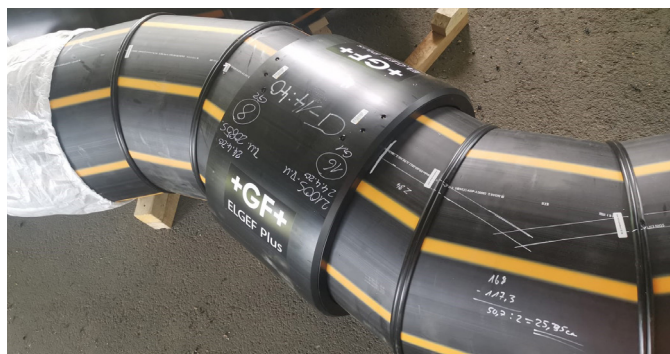
Módulos de nível pré-fabricados: curvas de segmento e acoplador ELGEF Plus.
