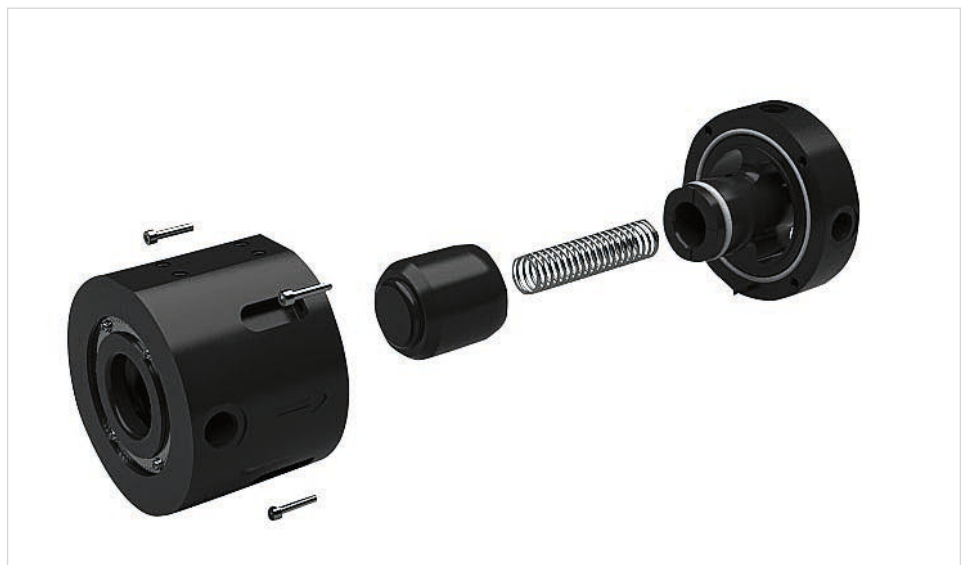
Fig. 3 Die Federmechanik des DRV vermeidet das sogenannte Aufschwingen, d. h., das Ventil verursacht keine Pfeifgeräusche bei starker Druckreduktion.
