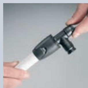
Spingere finché il tubo non è completamente inserito e visibile nella spia visiva
