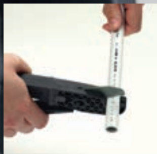
Inserire il primo tratto conico del raccordo nella tubazione
