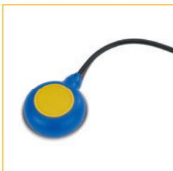
Der Typ 2285 schwimmt auf der gemessenen Flüssigkeit, weil seine relative Dichte kleiner als die des Wassers ist. Er schaltet, wenn der Kontakt einen Winkel von  $\pm 45^\circ$  erreicht.
