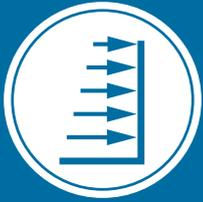
An der Tankwand montiert oder von oben in den Tank getaucht – ein hydrostatischer Sensor misst das Gewicht einer Wassersäule. Die Änderung des Drucks auf den Sensor ist proportional zur Änderung des Füllstands im Tank. Eine Kapillare im Kabel gewährleistet, dass Änderungen des atmosphärischen Drucks kompensiert werden können.
