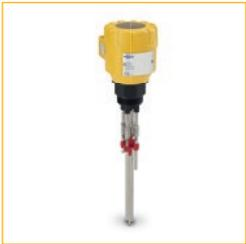
Misst leitfähige Prozessflüssigkeiten. Bei Erreichen eines gewünschten Füllstands fungiert das Medium als Übertragungsmedium für eine niedrige Spannung. Auf diese Weise liefert ein Relais eine Grenzstandmeldung.
