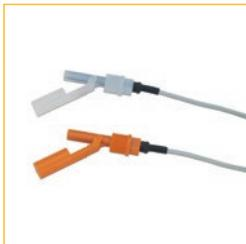
Der Schalter wird an der Seite des Behälters montiert. Ein schwenkbarer Kunststoffschwimmer mit einem Magneten bewegt sich auf der Flüssigkeit je nach Füllhöhe nach oben oder unten. Der eingekapselte Reedkontakt wird durch den Magneten aktiviert.
